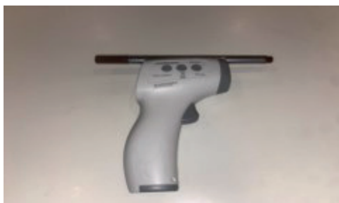
Abb. 2: Infrarot-Wärme-Messgerät mit Stift als Abstandshalter
